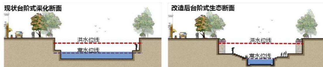
图 8-11 台阶式渠化断面改造前后断面图
